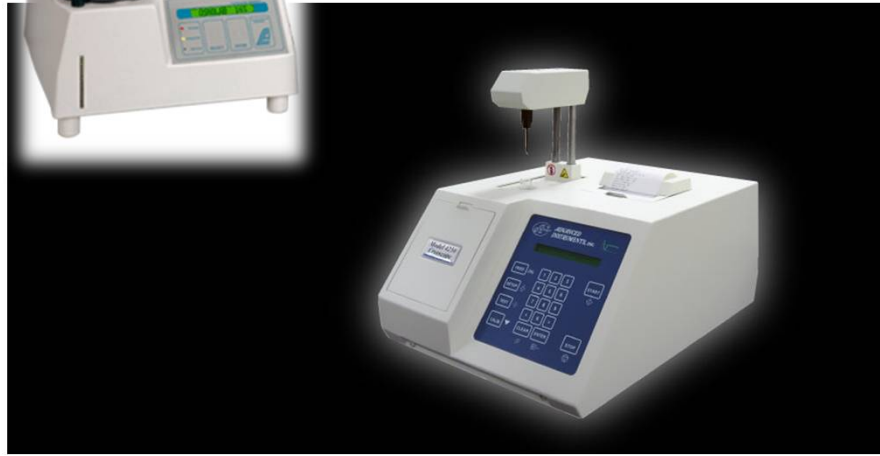
Kriyoskop (donma noktası ölçüm cihazı)
