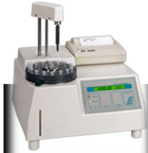
Kriyoskop (donma noktası ölçüm cihazı)
